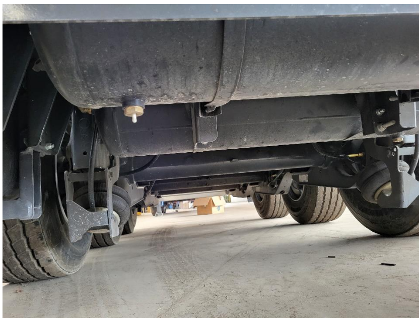
Rys. 6 Zawór odwadniający zbiornika ciśnieniowego
